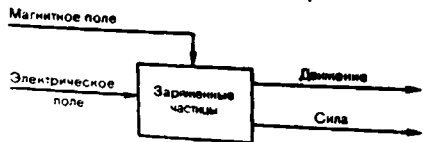
Рис. 91. Структурная схема ФЭ силы Лоренца
