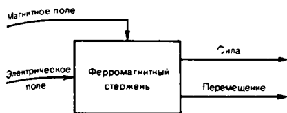
рис. 15. Структурная схема ФЭ Видемана
