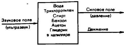
Рис. 50. Структурная схема звукокапиллярного эффекта
