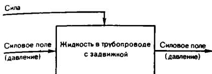
Рис. 22. Структурная схема ФЭ гидравлического удара
