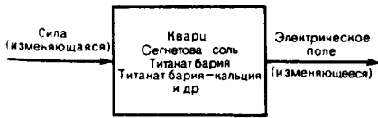
Рис. 36. Структурная схема прямого пьезоэлектрического эффекта
