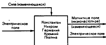
Рис. 49. Структурная схема тензорезистивного эффекта
