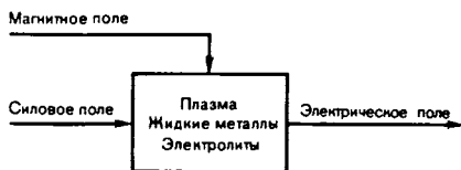
Рис. 20. Структурная схема магнито-гидродинамического эффекта
