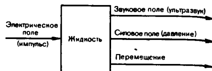
Рис. 114. Структурная схема электрогидравлического эффекта
