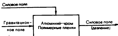
Рис. 93. Структурная схема ФЭ солнечного паруса
