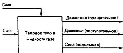
Рис. 66. Структурная схема ФЭ Магнуса
