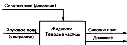
Рис. 103. Структурная схема ультразвукового диспергирования
