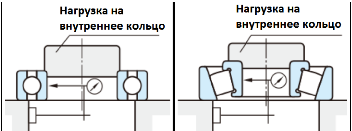
Рис.69 Измерение радиального биения внутреннего кольца подшипника в сборе. Внутреннее кольцо проворачивается на полный оборот. Иллюстрация "Коуро".
